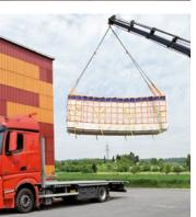
Die swisspor AG hat das im Jahre 2004 eingeführte Entladesystem «BIG MAMMA» überarbeitet, weiterentwickelt und verbessert. Dadurch wird dem Art. 61 der Kranverordnung, gestützt auf das Unfallversicherungsgesetz (UVG), nun ausnahmslos Rechnung getragen. Hierzu wird neu die zu hebende Last mit einem speziell entwickelten Netz zusammengehalten und gesichert.
